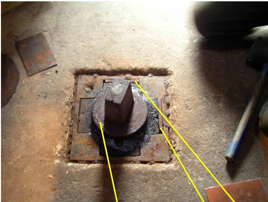
»Mühleisen«, - hier das »Hals-Lager« bzw. »Lagerstelle vom Mühleisen« mit den vier 4 schwarzen »Nöten« und den beiden »Spann-Keilen«
