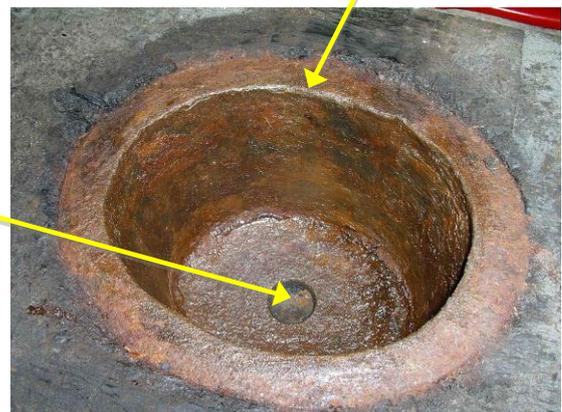
Diese Kugel gehört in die kulottenartige Vertiefung von dem »**Spurtopf**«.
